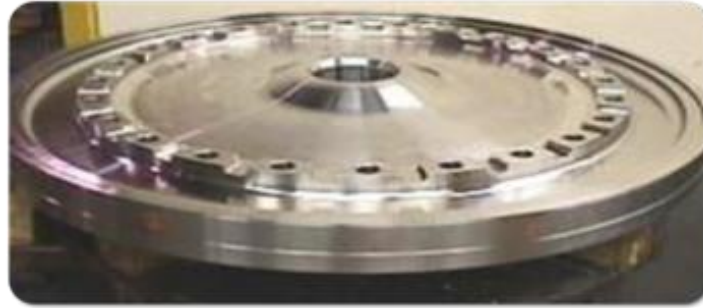
壓縮器(Compressor)轉盤 (大型鍛造合金鋼)
